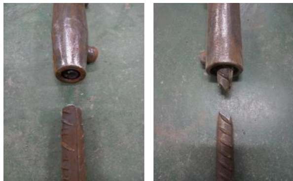
钢筋拉断破坏
