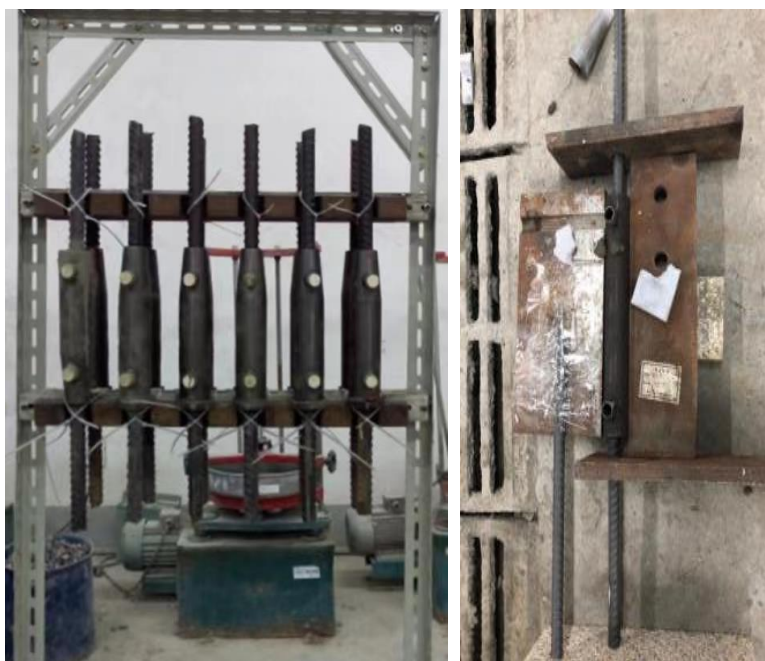
灌浆套筒试件制备
